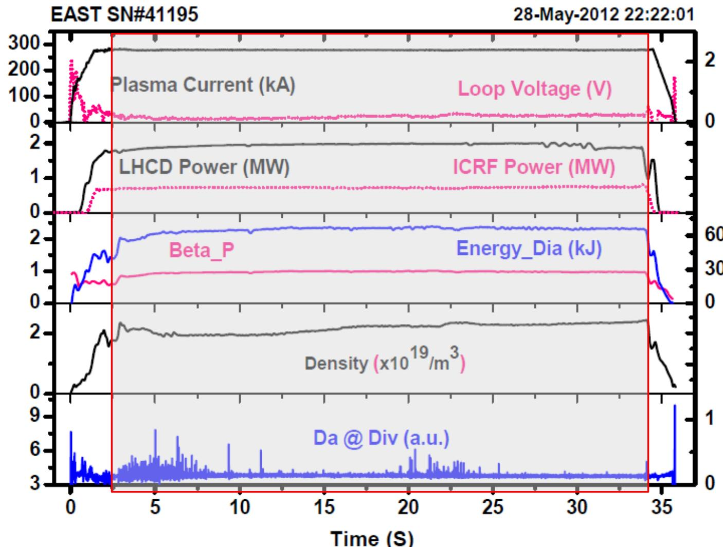
$I_p \sim 0.28\text{MA}$ ,  $B_t \sim 1.85\text{T}$ ,  $P_{LH} \sim 2.0 \text{ MW}$ ,  $P_{RF} \sim 0.75\text{MW}$ ,  $f = 27\text{MHz}$ ,  $\text{Beta}_P \sim 1.0$ ,  $H_{98} \sim 0.8$
